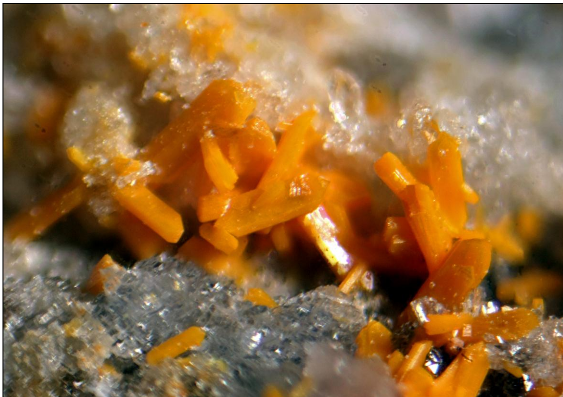
Figura 6: Kasolita mostrando el hábito típico de la especie, en forma de tabletas terminadas en punta. Pozo N° 3. Encuadre 2 mm.
